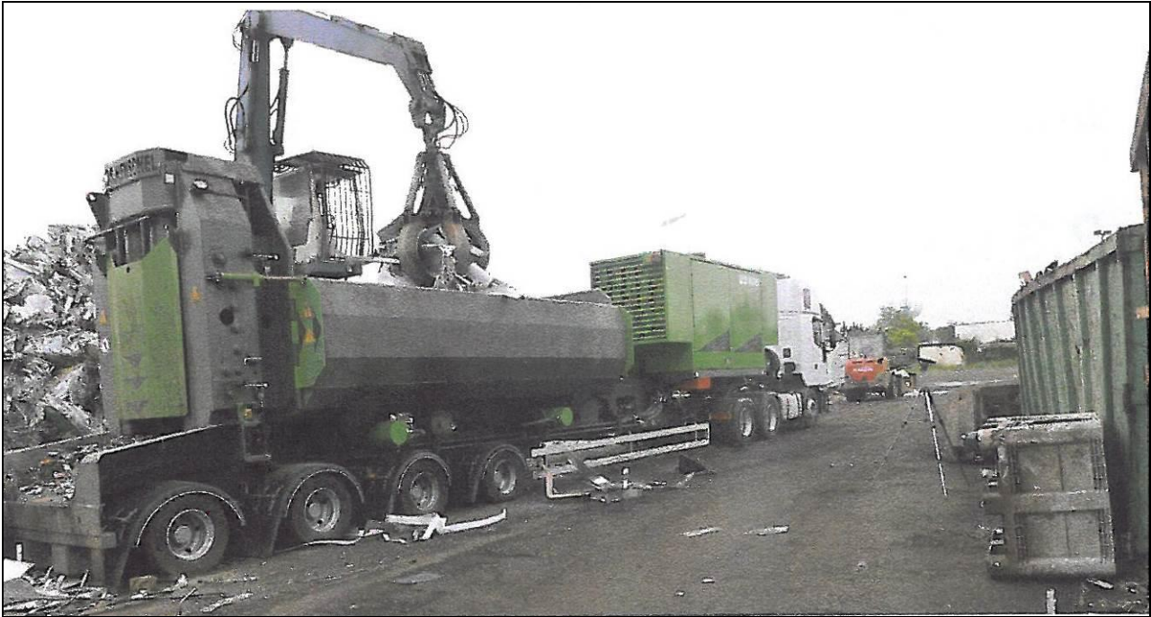
Figure 37 : Exemple de presse-cisaille mobile
